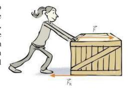
Aunque el rozamiento disminuye notablemente el rendimiento de ciertos mecanismos como el de los pistones de un motor, en algunas ocasiones es útil pues si no existiera la fricción varios sistemas no funcionarían, como por ejemplo, los frenos de los vehículos.
