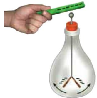
Figura 3. En el electroscopio al acercar un cuerpo cargado, las laminillas se separan al quedar cargadas con el mismo tipo de carga.
